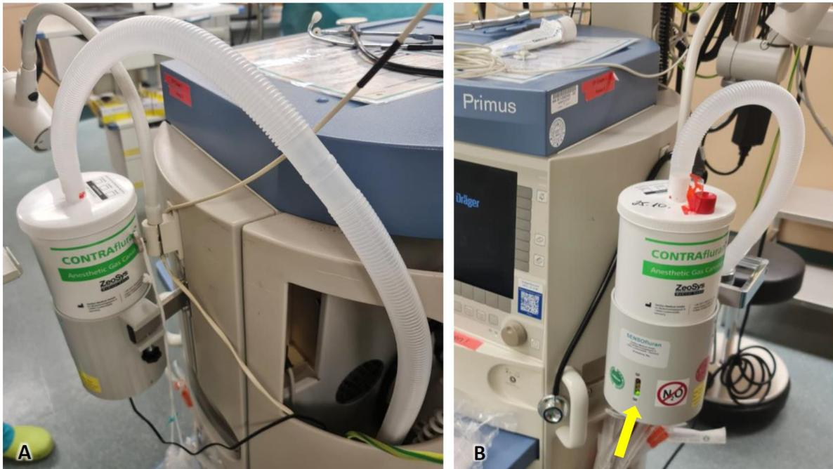
Bild: Aktivkohlefilter CONTRAfluran an Dräger Primus. Bild A: seitliche Ansicht mit Schlauch. Bild B: frontale Ansicht, das grüne Licht (gelber Pfeil) signalisiert einen aufnahmefähigen Filter mit ausreichend freier Kapazität.
